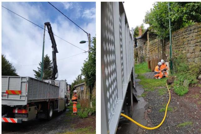
Poursuivant la modernisation des matériels et l'amélioration des conditions d'utilisation, nous avons procédé à la rénovation de notre camion réservé à la pose et la dépose de mâts d'éclairage. Nous l'avons équipé d'une radio commande pour faciliter l'utilisation de la grue auxiliaire et d'un compresseur thermique pour permettre l'utilisation d'outils pneumatiques (clefs à choc, marteau, etc...)
