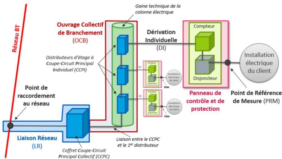
Schéma de raccordement d'une colonne montante
